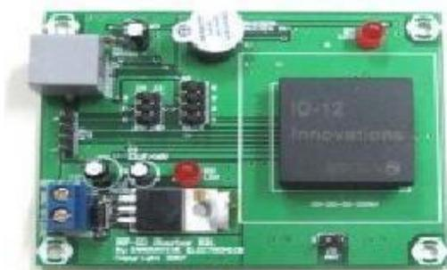
**Gambar 5: RFID Reader tipe ID-12**
