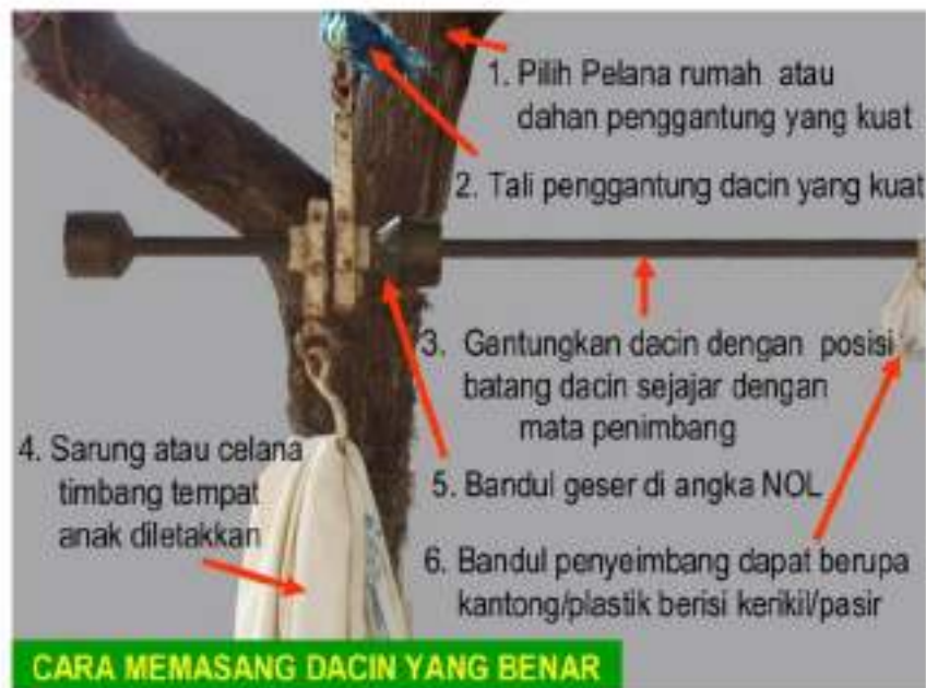
Gambar 6.2 Timbangan dacin dan pemasangannya.
